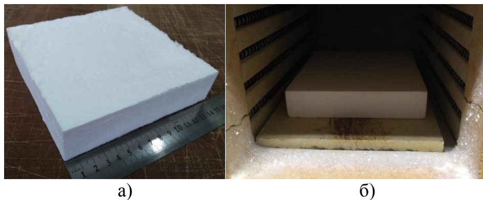
Рисунок 43 – Фотографии крупногабаритного образца ВПКМ: исходный (а) и модифицированный ФП марки ППУ-90 (б).
