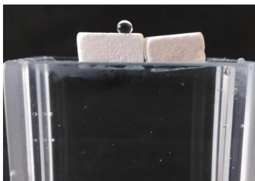
Рисунок 50 – Фотография образцов гидрофобного МПМ в кювете с водой.
