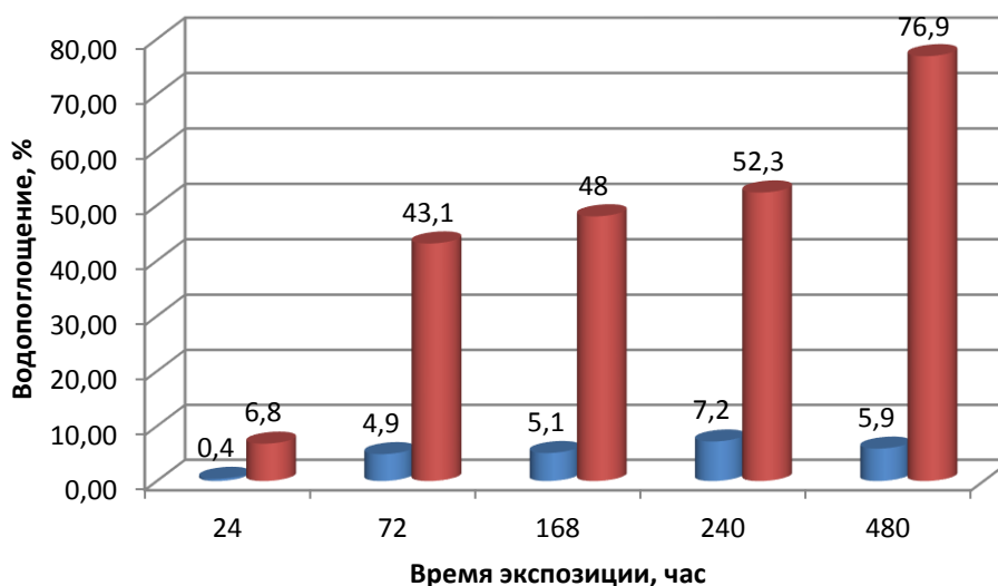
Рисунок 51 – Гистограмма распределения значений водопоглощения образцов МПМ, полученных методом сверхкритической сушки в изопропиловом спирту (синий цвет) и диоксиде углерода (красный цвет).
