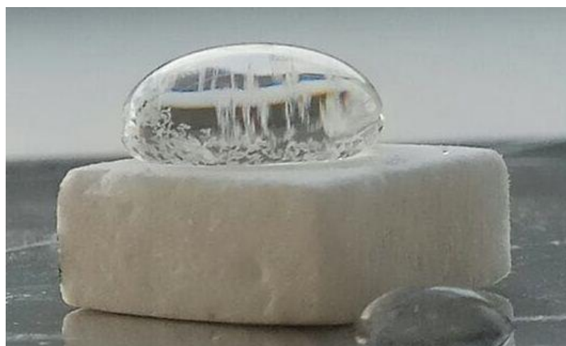
Рисунок 12 – Фотография воды на поверхности образца ВПКМ, модифицированного ФП марки ППУ-90.
