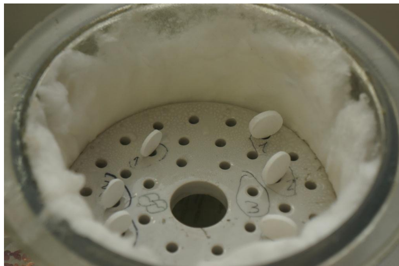
Рисунок 22 – Процесс испытания по определению влагопоглощения модифицированных образцов ВПКМ в эксикаторе над зеркалом воды.
