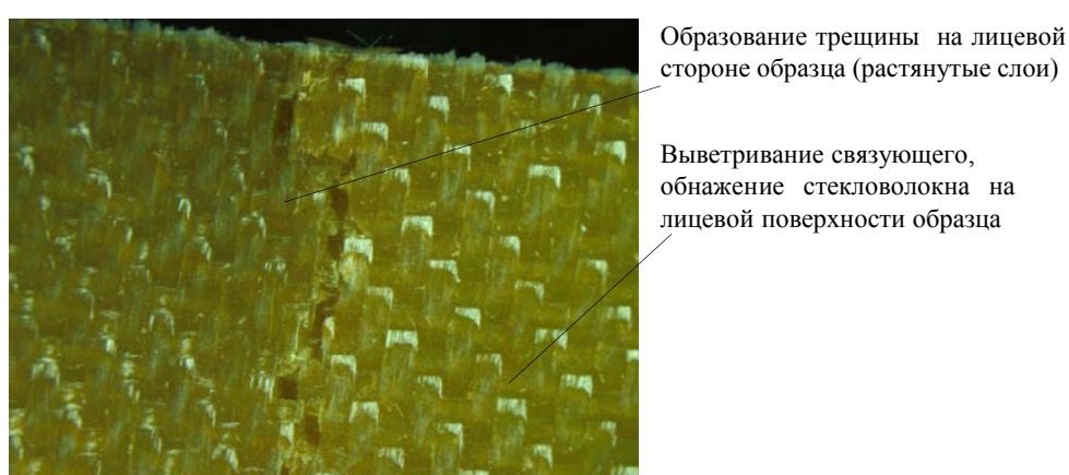
Рис. 1. Трещинообразование и выветривание связующего на лицевой стороне образца стеклопластика на связующем ВСЭ-20
