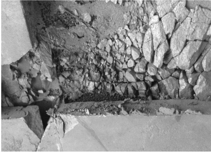
Рисунок 3. Фрагменты разрушенного керамического элемента после импульсного нагружения
