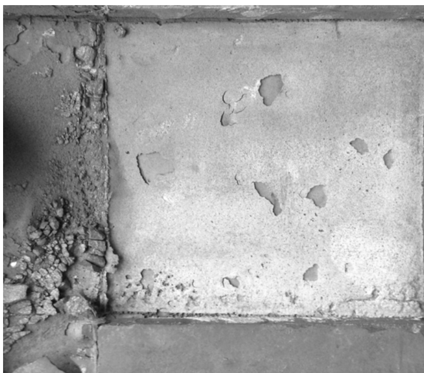
Рисунок 1. Характер разрушения при отслаивании пластины из карбида кремния от алюминиевого сплава
