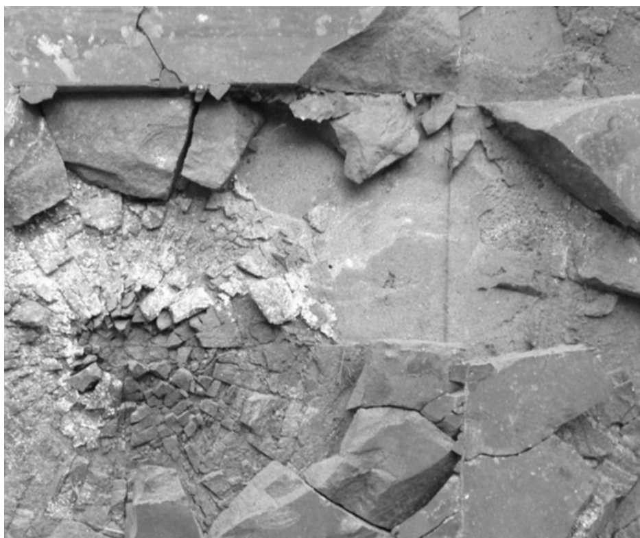
Рисунок 2. Разрушение керамической пластины вне зоны импульсного нагружения
