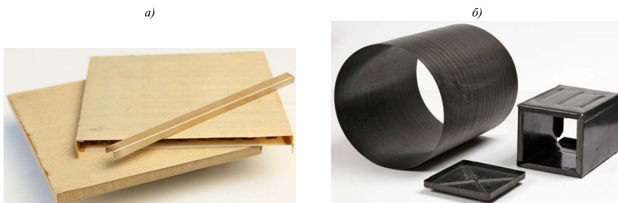
Рисунок 2. Трехслойная панель из стеклопластика СП-38Т и детали приборов из КТМУ-1, полученные сваркой растворителем (а) и тепловой сваркой (б)
