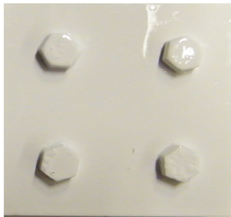
С комплексной защитой, включающей неорганические покрытия, разделительные слои и ЛКП на основе эмали ВЭ-69
