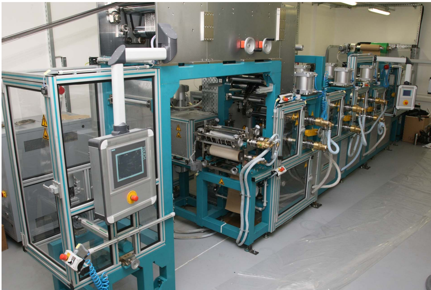
Лабораторная пропиточная линия СОАТЕМА LS-11 (Германия) для отработки технологических параметров процесса производства прецизионных калиброванных препрегов на основе высоковязких расплавных и клеевых связующих и различных видов наполнителей
