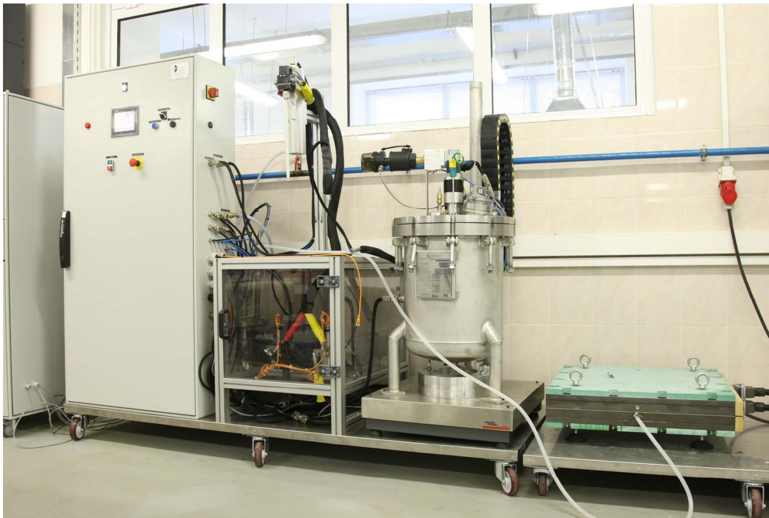
Установка для изготовления полимерных композиционных материалов с пособиями вакуумной инфузии и пропиткой под давлением
