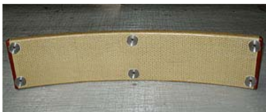
Панель силовая реверса
