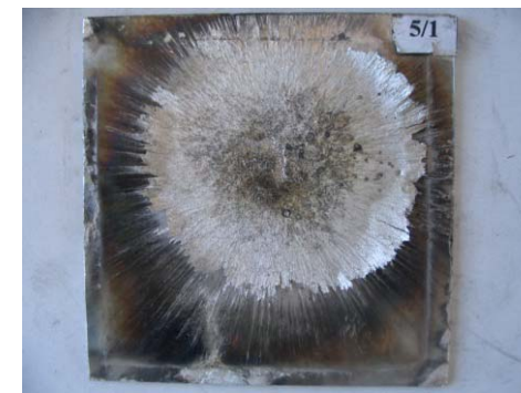
Образец алюминиевого сплава толщиной 2 мм после воздействия токов молнии с параметрами I=200 кА, Q = 20 Кл (зона В)
