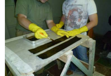
Выкладка препрега и укладка оптического волокна с ВБР
