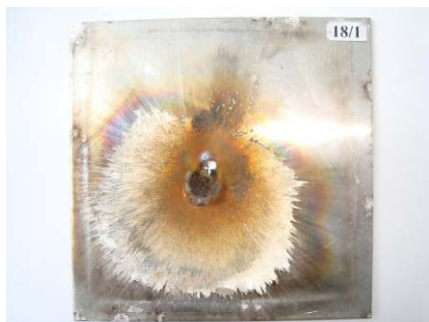
Образец алюминиевого сплава толщиной 2 мм после воздействия токов молнии с параметрами I=200 кА, Q = 200 Кл (зона А)
