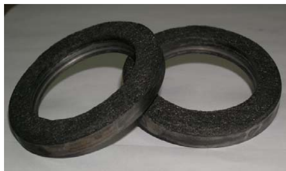
Рисунок 3. Внешний вид образцов пористого износостойкого материала с тонкопленочным покрытием после испытания на окисляемость и термостойкость
