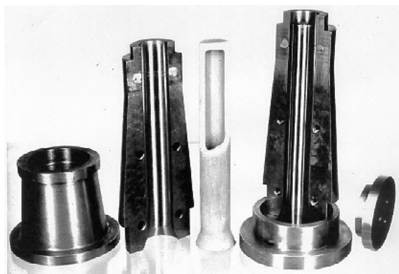
Рисунок 1. Пресс-форма и алундовый тигель, получаемый в ней
