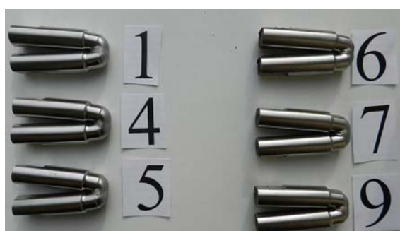
Рисунок 5. Образцы после испытаний на статический угол изгиба, проведенных на вертикальном прессе
