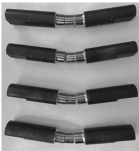
Рисунок 8. Термоупроченные образцы после испытаний на статический угол изгиба
