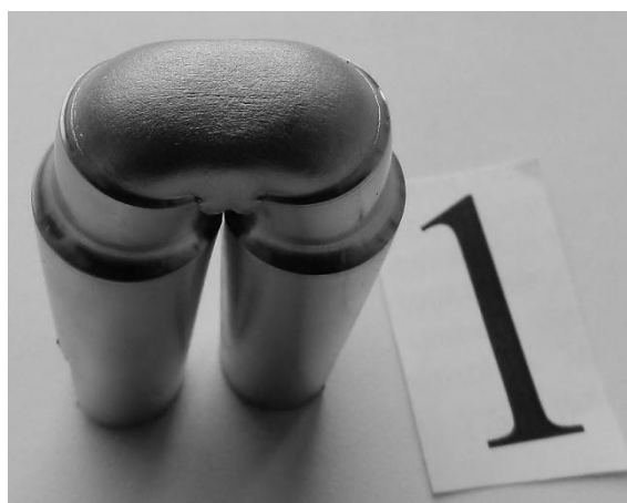
Рисунок 6. Вид растянутой зоны закаленного образца после испытания на статический угол изгиба, проведенного на вертикальном прессе
