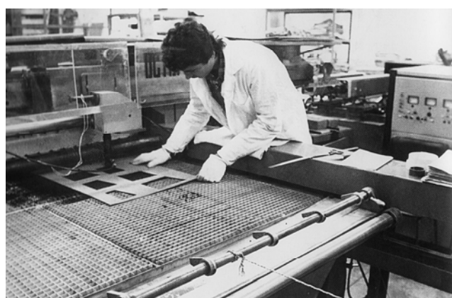
Рисунок 3. Лазерная установка для раскроя материала АТМ-15ПК
