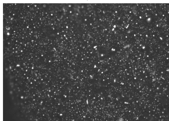
Внешний вид (а – \times 50 ; б – \times 100 ) поперечного разреза ленты порошкового припоя на органическом связующем
