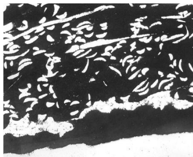
Рисунок 1. Микроструктура ( \times 100 ) паяного соединения ПВМ, выполненного припоем ВПр36 при температуре пайки 1260^{\circ}\text{C}
