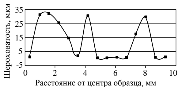
Рисунок 4. Изменение степени шероховатости поверхности при попадании глубоких коррозионных питтингов в область секущей, проведенной по поверхности образца
