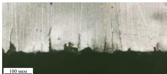
Рисунок 3. Трещины на торце образца из углепластика, подготовленного для испытаний
