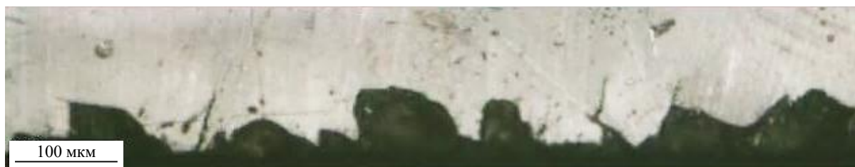
Рисунок 4. Сколы на торце образца из углепластика, подготовленного для испытаний
