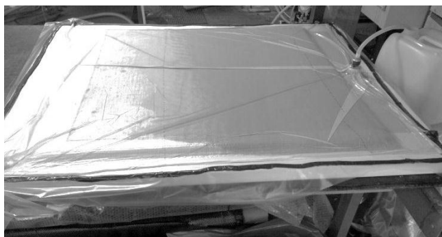
Рисунок 1. Технологический пакет в процессе вакуумной инфузии
