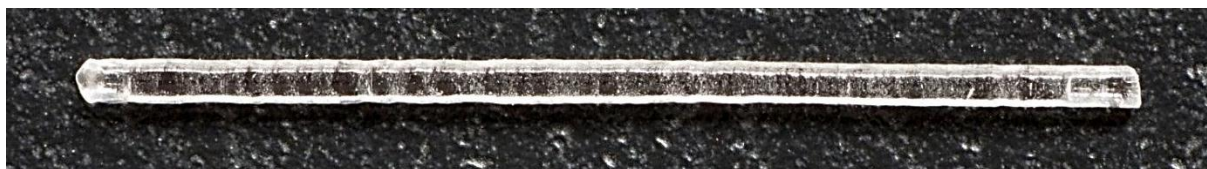
Рисунок 2. Колебания толщины монокристаллического волокна \text{Al}_2\text{O}_3 по длине ( \times 50 )
