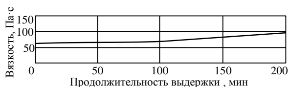
Рисунок 1. Зависимость кажущейся вязкости эпоксиангидридного связующего марки ВСЭ-33 от продолжительности выдержки при температуре 50^\circ\text{C} (изотермический режим)
