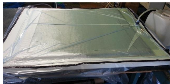
Рисунок 2. Вакуумирование технологического пакета в процессе вакуумной инфузии
