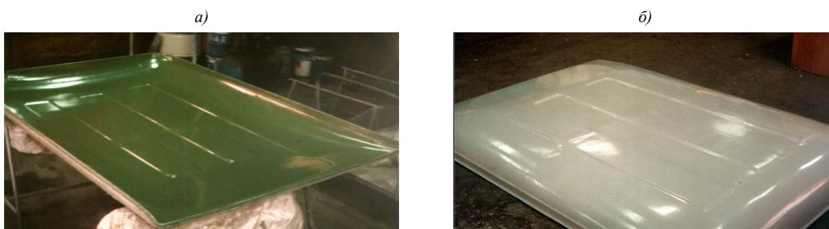
Рисунок 7. Форма для изготовления крыши автомобиля (а) и готовое изделие (б)
