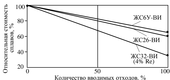
Рис. 6. Относительная стоимость серийных жаропрочных никелевых сплавов
