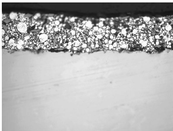
Рисунок 5. Микроструктура образца из стали ВКС-170 с коррозионностойким шликерным покрытием АХФ+Al+Si после 2136 ч испытаний на общую коррозионную стойкость в камере солевого тумана (КСТ-35)
