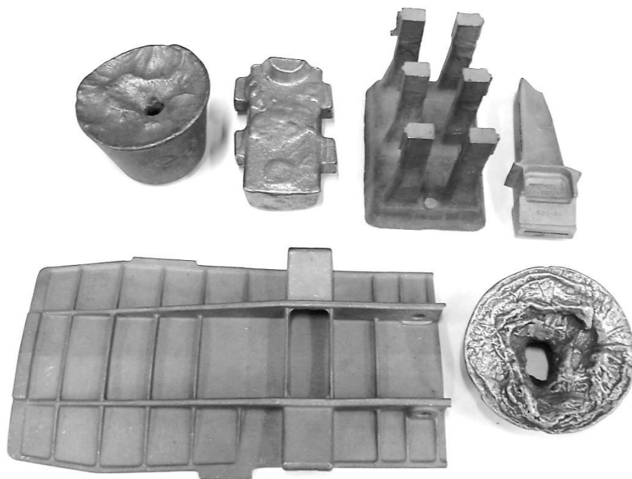
Рисунок 1. Внешний вид отходов из жаропрочных никелевых сплавов, поступающих на переработку
