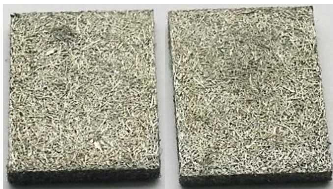
Рисунок 3. Образцы истираемого уплотнительного материала из волокон медного сплава
