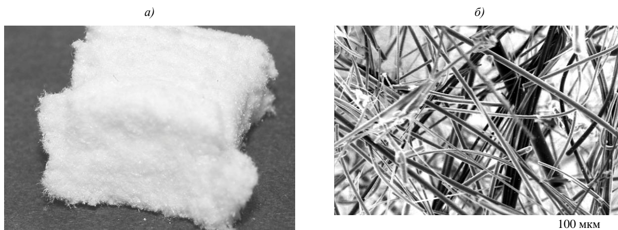
Внешний вид ( a ) и микроструктура ( б ; СЭМ) гибкого уплотнительного материала из дискретных волокон на основе оксида алюминия с добавлением кварцевого волокна
