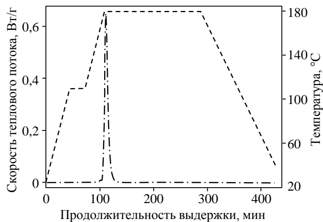
Рисунок 7. Температурная зависимость ДСК-сигнала (— · —) согласно заданной температурной программе (---)
