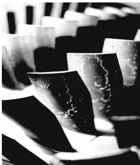
Рисунок 1. Титановые лопатки компрессора ГТД с солевыми отложениями
