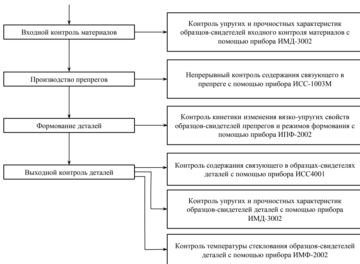
Рисунок 1. Основные направления контроля ПКМ, лабораторные и технологические средства контроля
