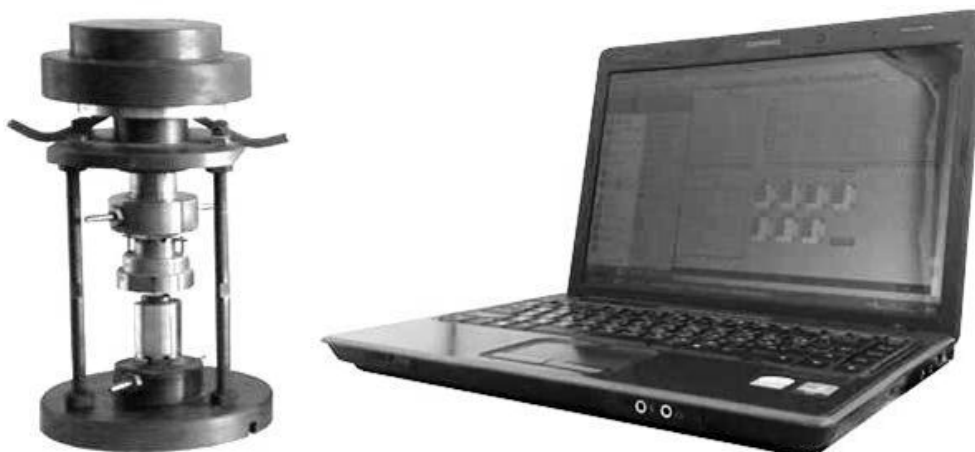
Рисунок 6. Лабораторная установка ИПФ-2003 для измерения параметров формования ПКМ
