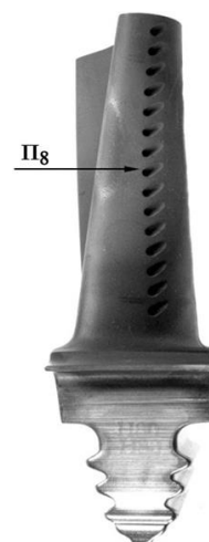
Рис. 1. Рабочая лопатка турбины высокого давления ГТД (общий вид со стороны входной кромки; стрелкой указано положение восьмого перфорационного отверстия)
