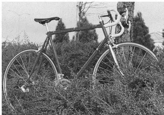
Рис. 5. Рама спортивного велосипеда из сплава АБМ1, изготовленная в ОАО «Композит» по заказу фирмы Brush Wellman (США)
