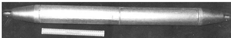
Рис. 3. Сварные раскосы из алюминиево-бериллиевого сплава АБМ1: а – из трубы с прутком; б – из листа с прутком
