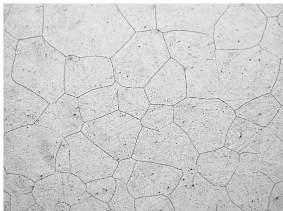
Рис. 1. Микроструктура стали ВКС-180-ИД (размер зерна 2–3 балла, границы зерна чистые)
