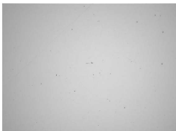
Рис. 2. Микроструктура стали ВКС-180-ИД (неметаллические включения не выше 1 балла)
