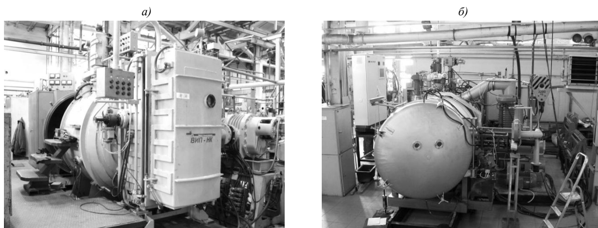
Рис. 2. Установки ВИП-НК (а) и УВНК-9А (б) для производства монокристаллических отливок образцов и лопаток
