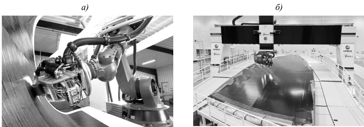
Рис. 1. Автоматизированная выкладка препрегов методами AFP (а) и ATL (б) с помощью роботизированной «руки» фирмы Coriolis Composites (а) и установки портального типа с горизонтальной балкой фирмы MТorres (б)
