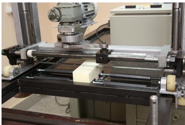
Рис. 2. Устройство для механической обработки вспененных полимерных материалов
