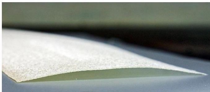
Рис. 3. «Корка», снятая с поверхности вспененного полимерного материала
