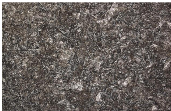
Сердцевина сварного шва после цементации и термической обработки
