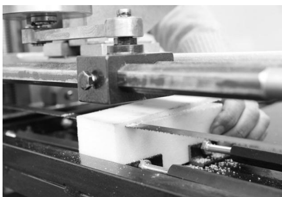
Рис. 3. Изготовление образцов из вспененных полимерных материалов
