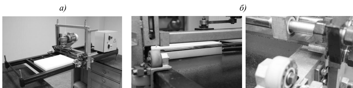
Рис. 1. Общий вид устройства ( a ) и держатель ножа ( б ) устройства для механической обработки вспененных полимерных материалов
