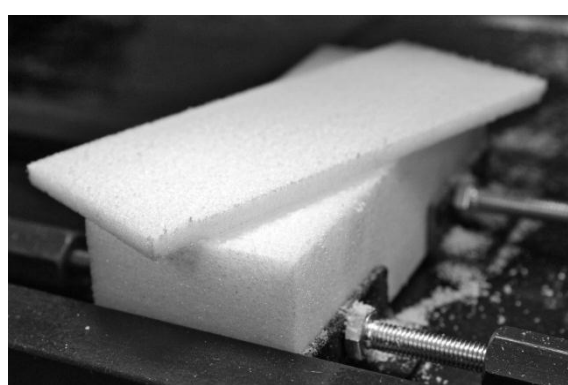
Рис. 3. Изготовление образцов из вспененных полимерных материалов
