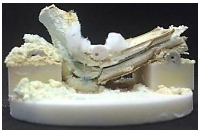
Рис. 3. Образец композиционного материала с матрицей на основе Nb после нагрева до 1300°C в воздушной атмосфере
