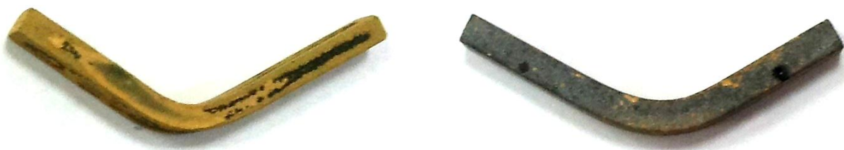
Рис. 5. Образцы с различными видами защитных покрытий после высокотемпературных испытаний в потоке аргона
