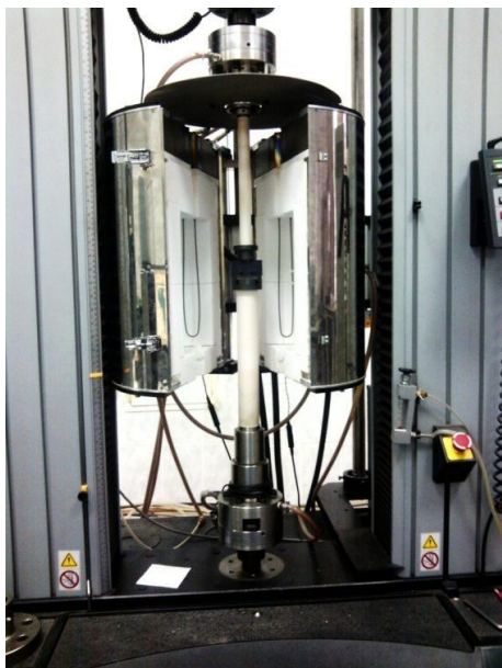
Рис. 1. Рабочее пространство печи, входящей в состав установки Instron 5882, со штатной оснасткой
