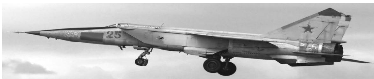
Рис. 3. Самолет МиГ-25, способный развивать скорость более 2,8 М (температура на поверхности до 230°C), остекленный фторакрилатным оргстеклом Э-2
