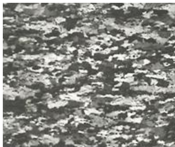
Рис. 3. Микроструктура ( \times 200 ) бериллия марки ТВ-200 в поляризованном свете
