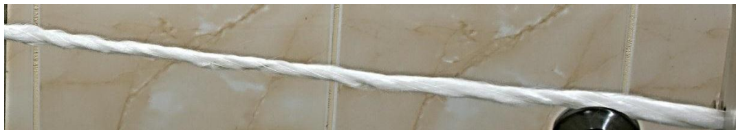
Рис. 6. Комплексная нить из непрерывного волокна на основе оксида алюминия с внешней обмоткой органическими нитями
