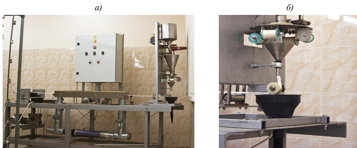
Рис. 4. Установка для внешней обмотки первичной термостойкой нити вспомогательными нитями (а) и узел вращающейся платформы с четырьмя катушками с вспомогательными нитями (б)
