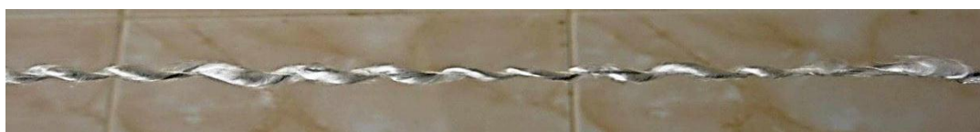
Рис. 5. Образец комплексной нити, изготовленный с большим натяжением вспомогательных нитей
