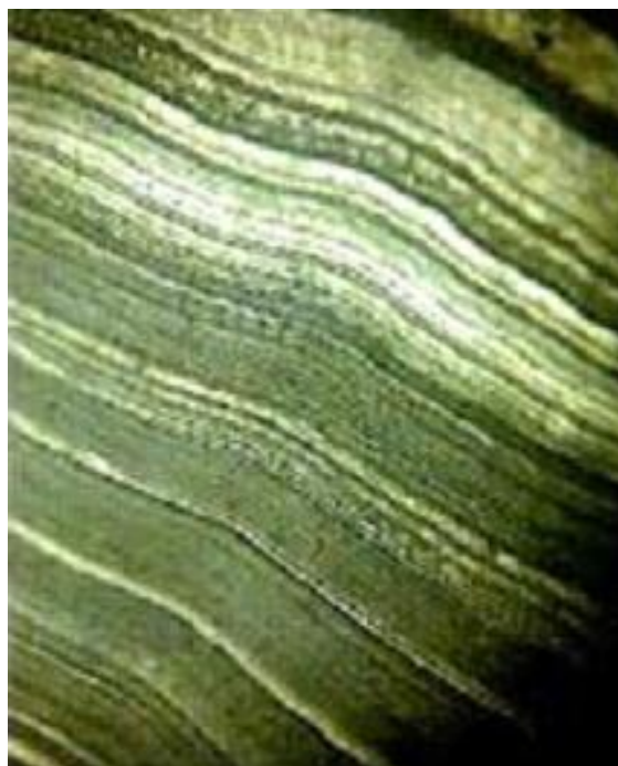
Рис. 4. Микрошлиф ( \times 500 ) горизонтально-слоистой структуры покрытия
