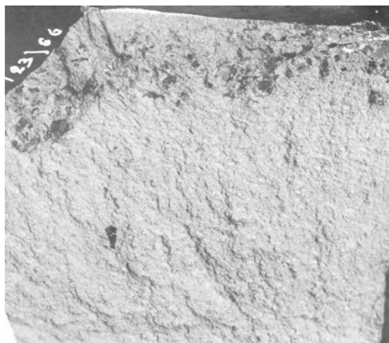
Рис. 2. Макроструктура излома отливки сплава МЛ10 с ликвационными включениями цирконидов
