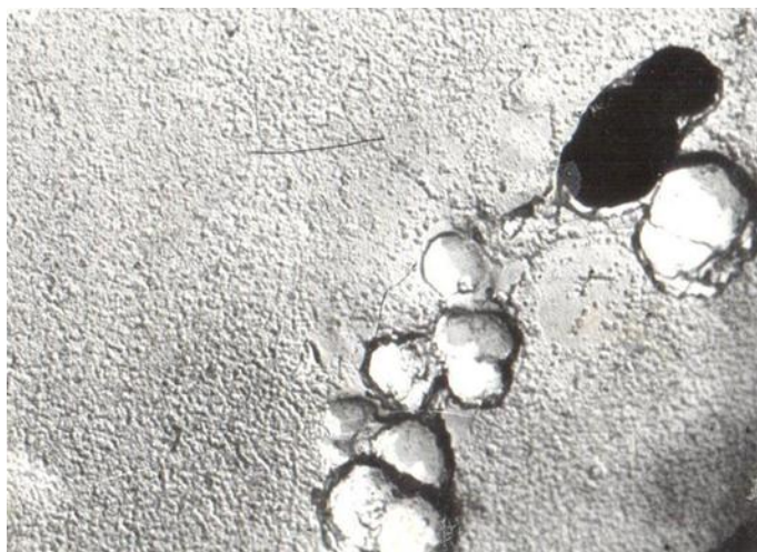
Рис. 1. Микроструктура ( \times 10\ 000 ) жаропрочного магниевого сплава с ликвационными включениями цирконидов
