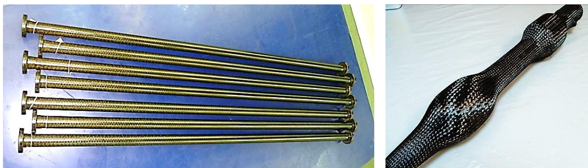
Рисунок 5. Образцы изделий с плетеной армирующей основой, изготовленных в КНИТУ-КАИ (Россия)
