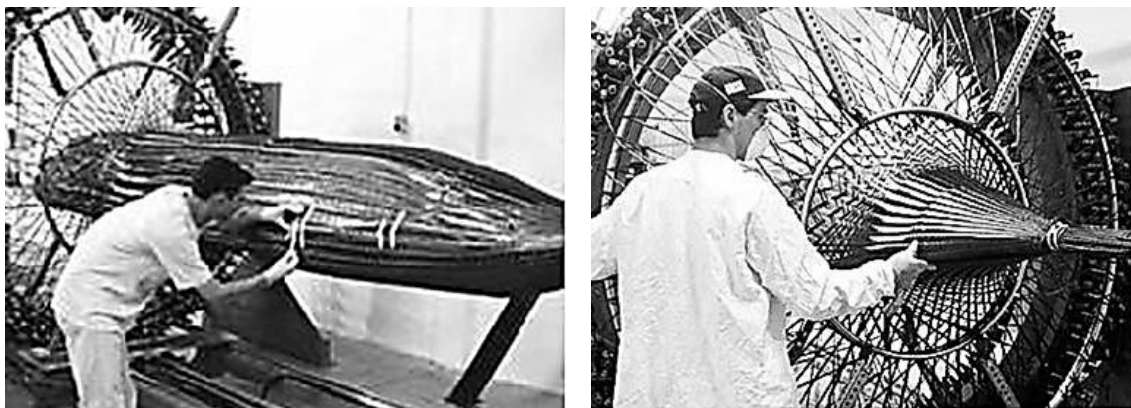
Рисунок 4. Применение плетеных преформ при изготовлении фюзеляжа ракет (компания Fiber Innovations)
