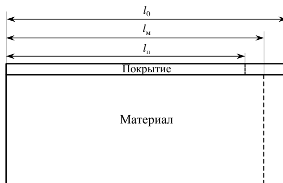
Рис. 1. Схема изменения размеров композиции «материал–покрытие» при охлаждении до комнатной температуры для случая \alpha_{\text{п}} > \alpha_{\text{м}} : l_0 – линейный размер покрытия и подложки при температуре напыления, мм; l_{\text{м}} – линейный размер образца подложки после охлаждения без учета покрытия, мм; l_{\text{п}} – линейный размер покрытия после охлаждения без учета связи его с подложкой, мм
