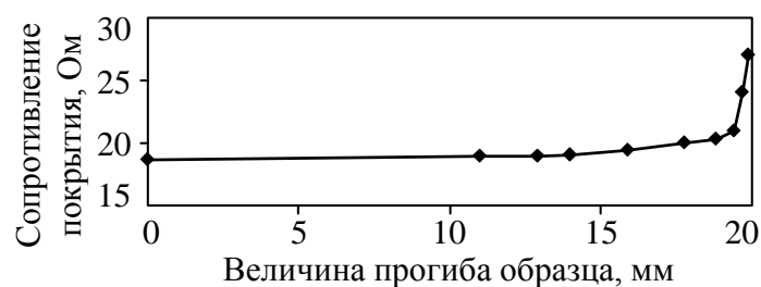
Рис. 4. Зависимость поверхностного сопротивления покрытия от прогиба h для первого варианта образца (В1) на основе ПЭТФ пленки с ITO покрытием, электродами и двумя листами поликарбоната (см. рис. 2)
