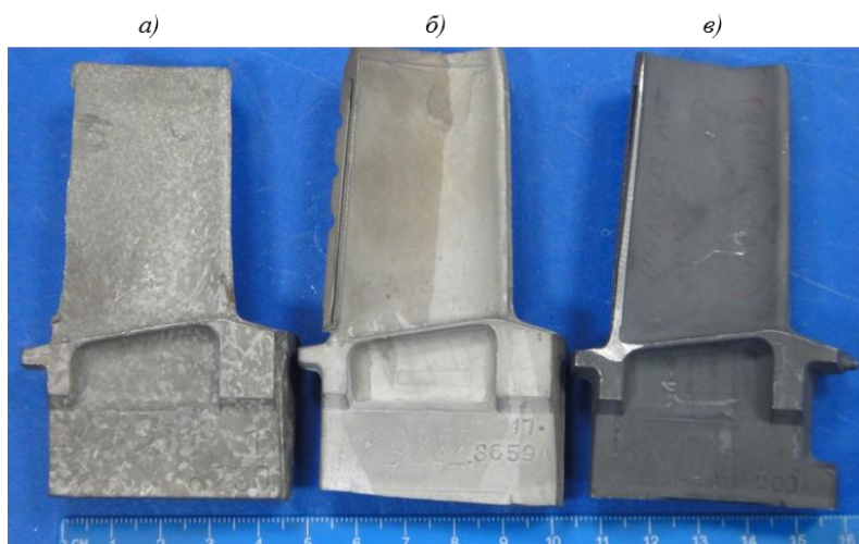
Рис. 1. Лопатки с равноосной (а), направленной (б) и монокристаллической (в) структурой
