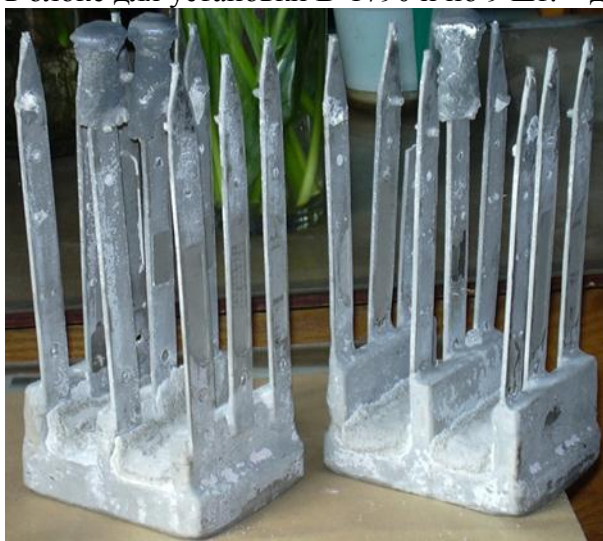
Рис. 14. Блоки двустенных монокристаллических образцов, имитирующих стенку лопатки с проникающим охлаждением
