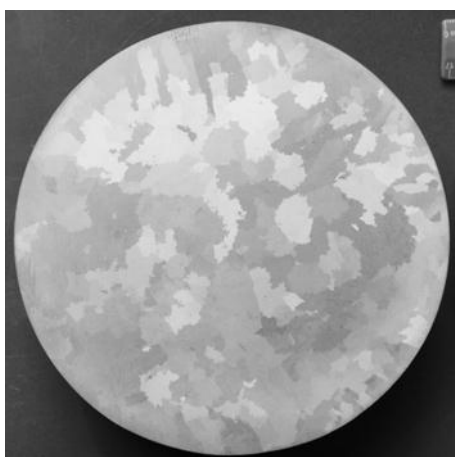
Рис. 2. Макроструктура материала стандартного образца жаропрочного никелевого сплава
