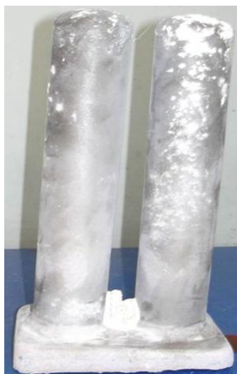
Рис. 3. Заготовки стандартного образца никелевого сплава, полученные методом направленной кристаллизации
