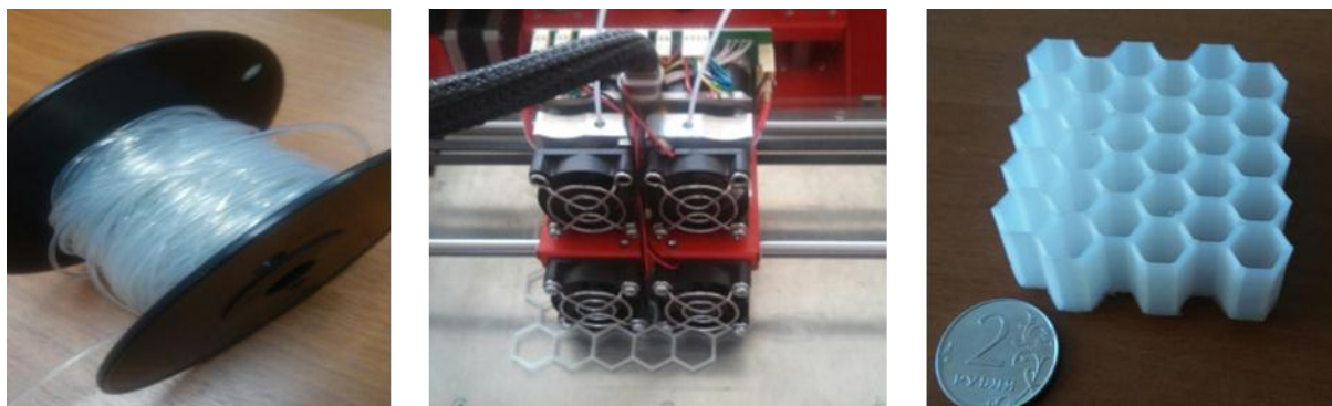
Рис. 4. Полимерная нить из ПА-12+3% ДБДФО диаметром 1,7\pm 0,1 мм (а), печать сотовой конструкции из ПА-12+3% ДБДФО (б) и сотовая конструкция (в)
