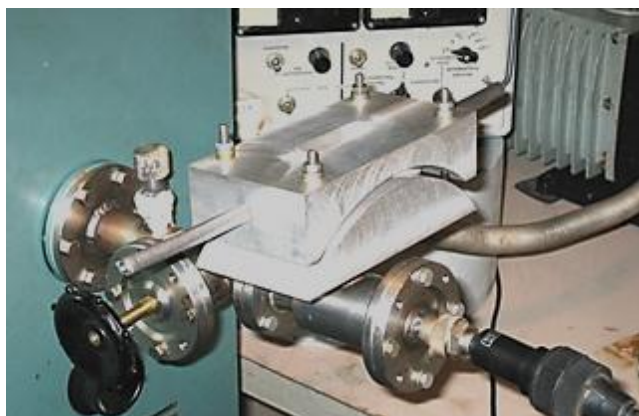
Рис. 10. Приспособление для испытания бериллиевого окна на вакуумную плотность
