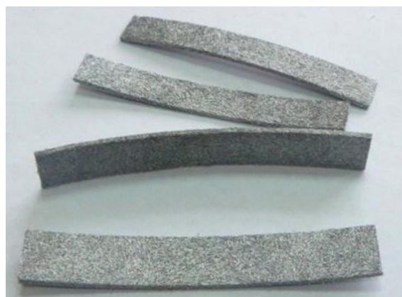
Рис. 1. Истираемый уплотнительный материал из дискретных металлических волокон
