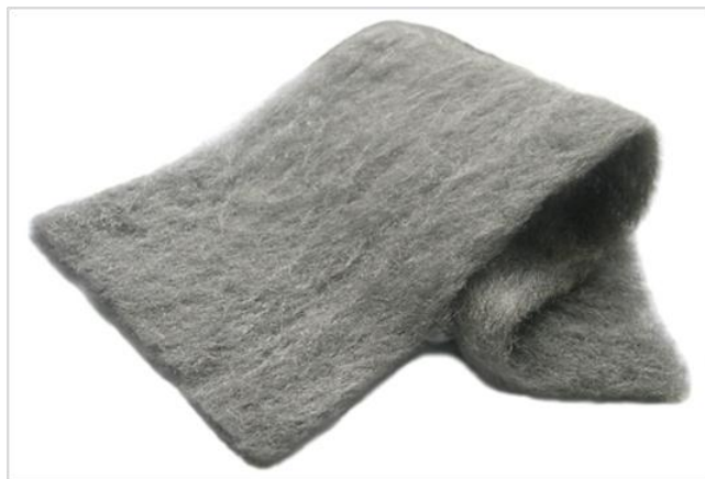
Рис. 5. Пористый материал из волокон сплава типа X23Ю5Т, полученный методом экстракции висящей капли расплава
