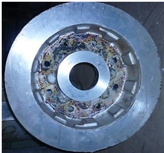
Рис. 3. Корпус авиаколеса из магниевого сплава МЛ12
