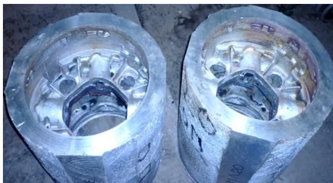
Рис. 6. Фасонные отливки из сплава ВМЛ20
