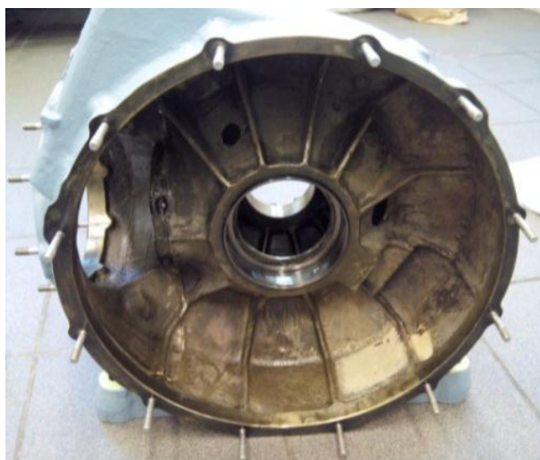
Рис. 5. Корпус редуктора вертолета из сплава ВМЛ18
